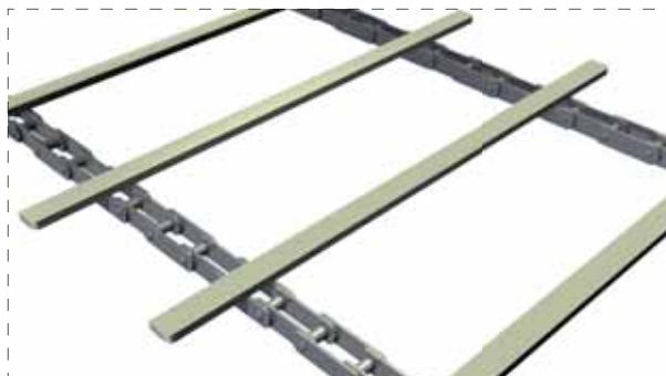
10800 Dubbelkedja M80A80 C/C 700 mellan kedjorna och medbringare L=1000 C/C 320
