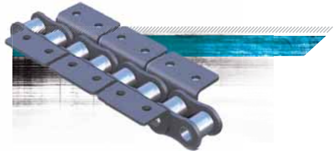
WK-2 Böjd länk, dubbelsidig med två hål på ytterlänk Se sida 126
